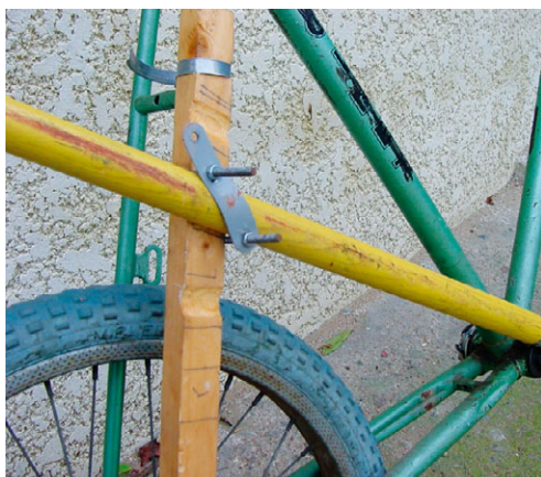
Il faut trouver la bonne inclinaison du manche avant de le fixer à la fourche.
